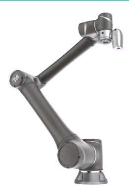
Der TM20 verfügt über eine höhere Tragfähigkeit in unserer Al-Roboterserie. Die erhöhte Traglast von bis zu 20 kg ermöglicht eine weitere Skalierung der Roboterautomatisierung und eine Steigerung des Durchsatzes für anspruchsvollere, schwerere Anwendungen. Er ist speziell für massive Pick-and-Place-Aufgaben, schwere Maschinenbeschickung und hochvolumige Verpackungs- und Palettieraufgaben konzipiert. Der TM20 eignet sich für eine breite Palette von Anwendungen in fast allen Branchen.
